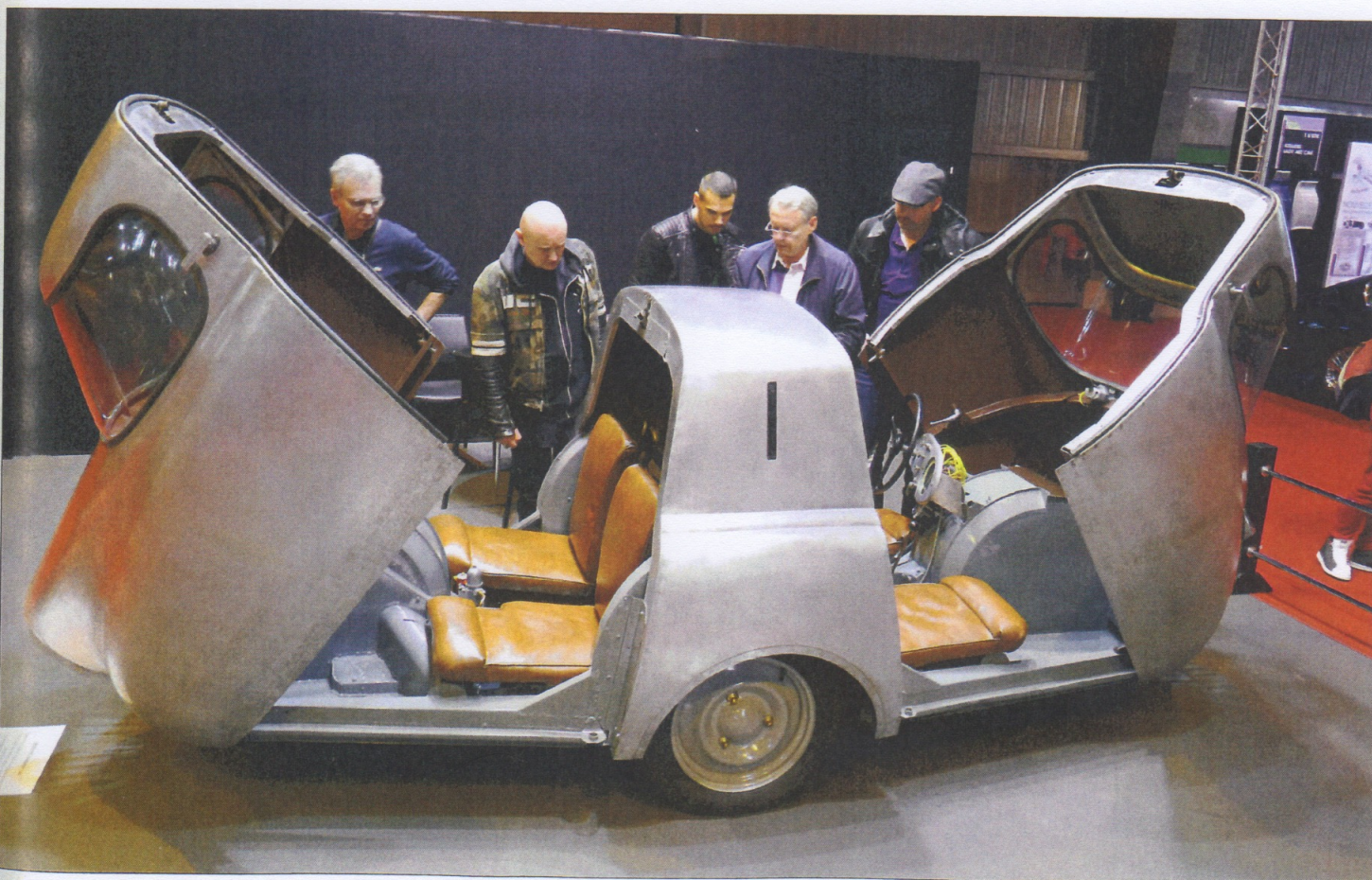
L'Alamagny 1947. Marcel Alamagnyn toteutus romboidista. Laitteen runko valmistettiin Amédée Gordinin pajalla, korista vastasi Pourtout. Simca 5:n moottori on joiitettu istuinten väliin. Lehden kannessa on sama auto ovet suljettuina.
