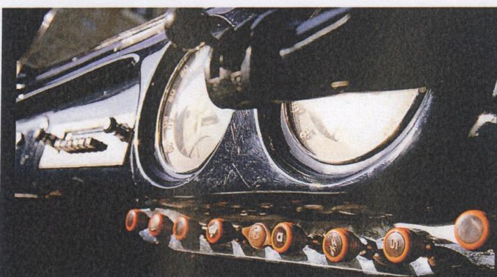
Auf dem Lenkstockhebel sitzt der winzige Schalthebel für das elektromagnetische Cotal-Getriebe. Damit lässt sich ohne zu kuppeln schalten
